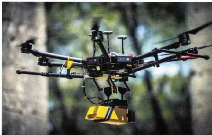
Les lidar de YellowScan sont destinés à l'équipement des drones et permettent une imagerie 3D optimale pour toutes fonctions topographiques. ©David Richard.
